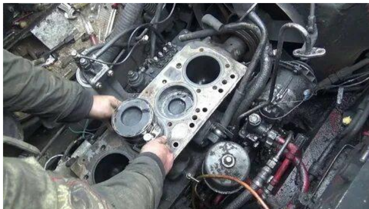
Рис. 3. Замена поршневых колец, не снимая двигатель с трактора Fig. 3. Replacing piston rings without removing the engine from the tractor Источник: разработано авторами по результатам исследований
